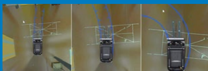
Automatische Zoom-Funktion, um langsame Manöver in beengten Umgebungen zu vereinfachen
