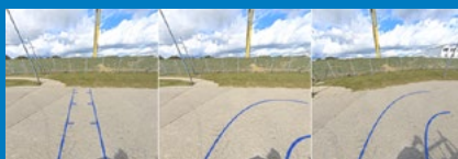
Digitales Schwenken der Kamera abhängig vom Lenkwinkel, ermöglicht dem Fahrer mehr des relevanten Bereichs zu überblicken
