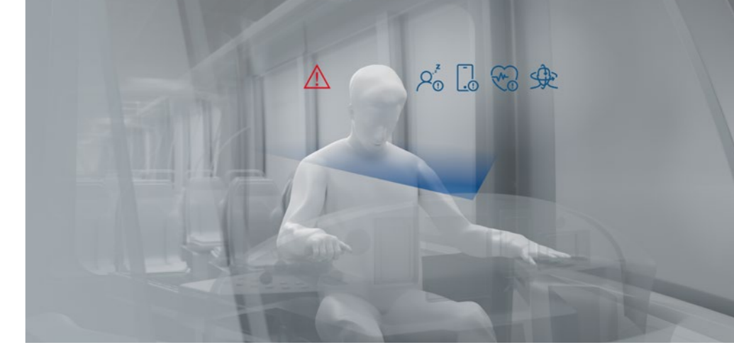
Nahbereichskamera erkennt Ablenkung des Fahrpersonals
