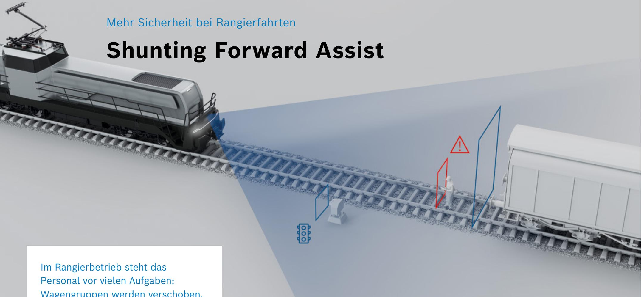
Im Rangierbetrieb steht das Personal vor vielen Aufgaben: Wagengruppen werden verschoben, Waggons an- oder abgekuppelt. Gleichzeitig ist der Bahnbetrieb auf Parallelgleisen zu beachten. Auf Rangierfahrten unterstützt und entlastet der Shunting Forward Assist das Rangierpersonal, indem er den Bereich vor dem Fahrzeug vorausschauend überwacht.
