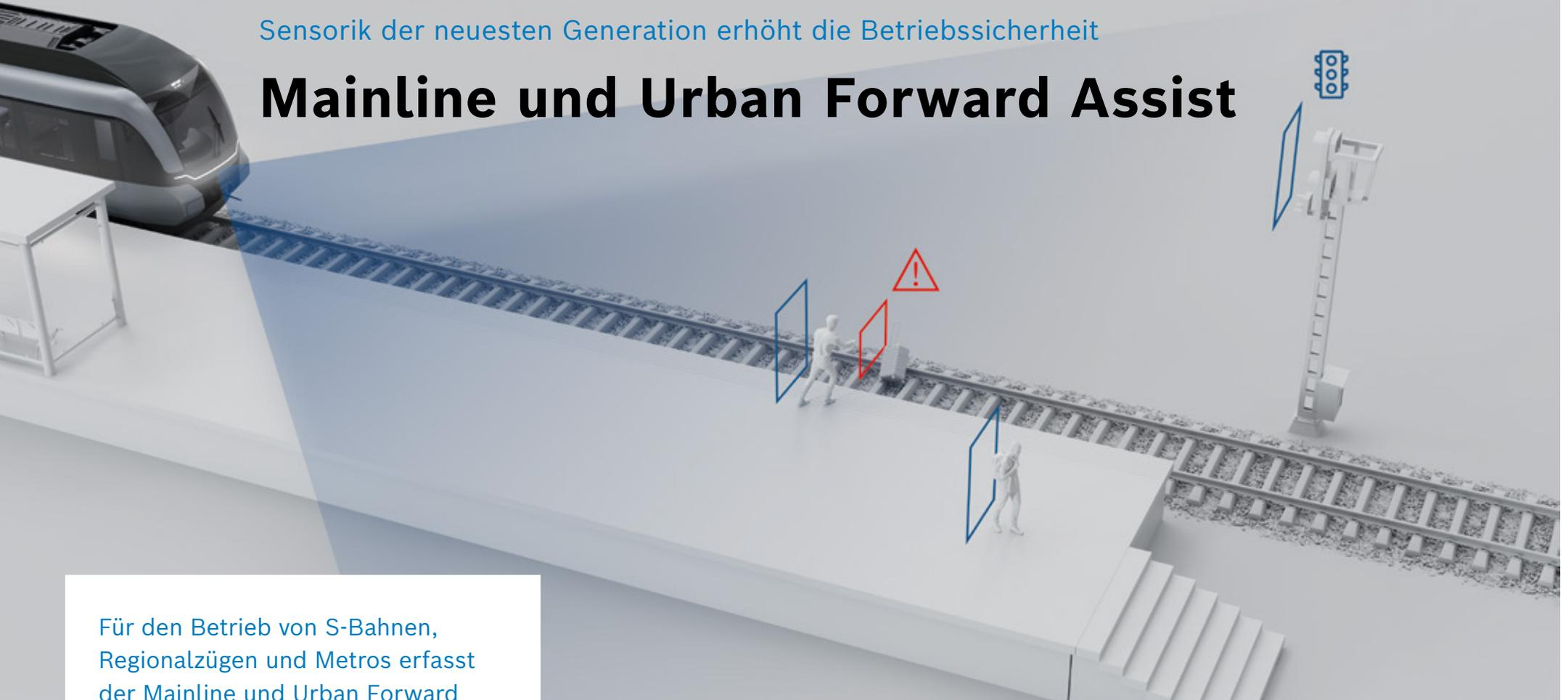
Für den Betrieb von S-Bahnen, Regionalzügen und Metros erfasst der Mainline und Urban Forward Assist vorausschauend das Umfeld vor den Triebfahrzeugen und an Bahnsteigen. Dies trägt zu mehr Sicherheit im Stationsbereich und auf freier Strecke bei.
